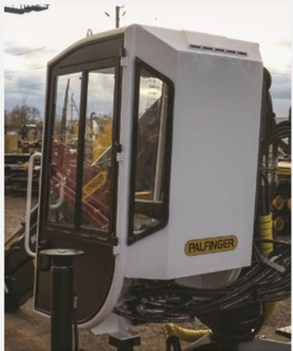
За комфорт в кабине отвечает специальный автономный дизельный обогреватель с дополнительным вентилятором направленного действия. Управление всеми функциями находится справа на специальной панели: кнопки аварийного останова и подачи сигнала, управление обогревателем и вентилятором, внутренним и наружным освещением, управление стеклоомывателем и стеклоочистителем. Внутри панели расположен блок предохранителей.
