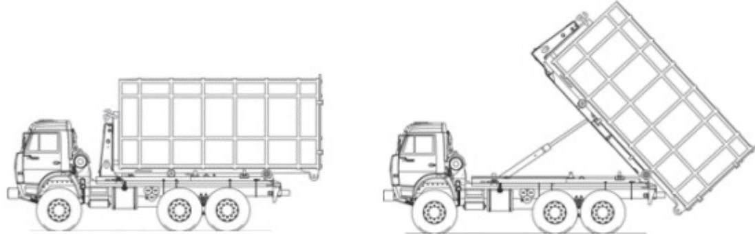
Режим снятия/установки бункера
