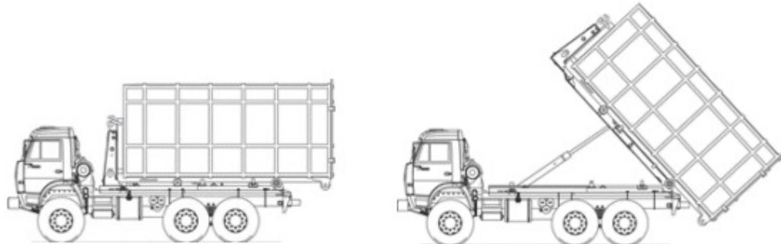
Режим снятия/установки бункера
