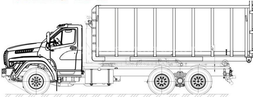
Самосвал Урал NEXT 73945 с системой мультилифт ST15
